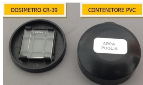
Figura 1a. Immagine del CR-39 e del contenitore in PVC.
